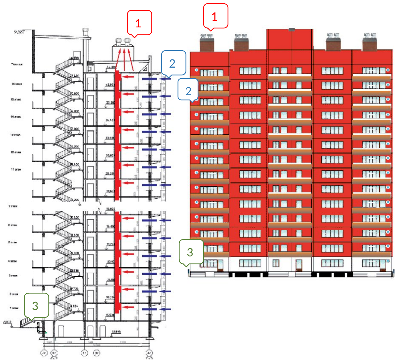
Рис. 4. Примеры установки устройств ROTADO на МКЖД
